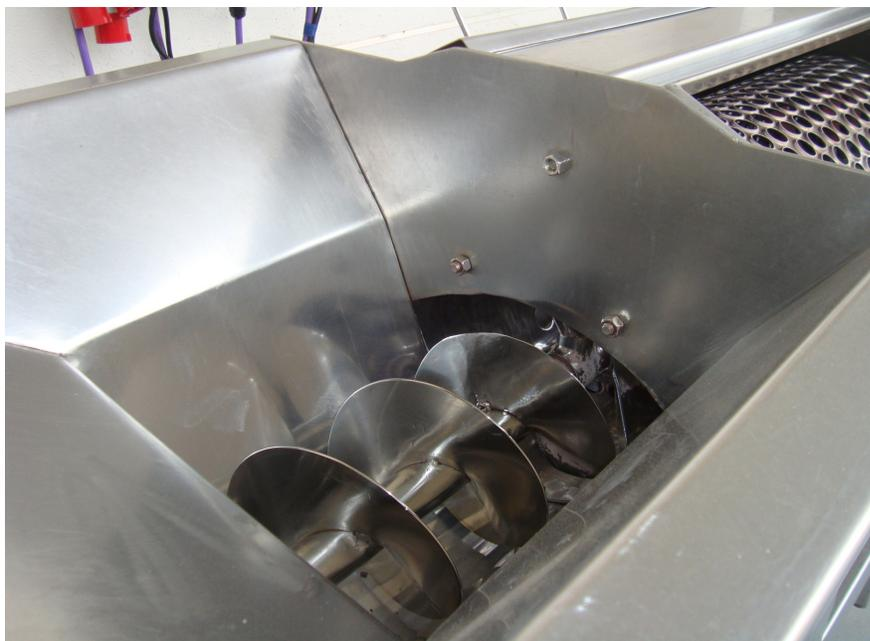
Foto 5: Interior de la descobajadora-moledora a escala piloto
