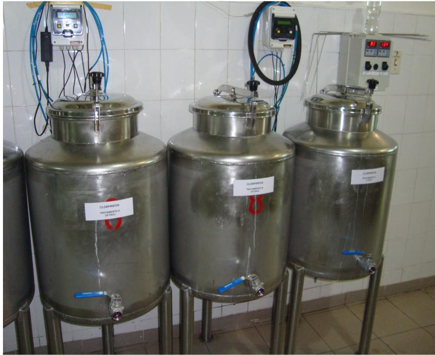
Foto 6: Tanques de acero inoxidable donde se produjo fermentación alcohólica
