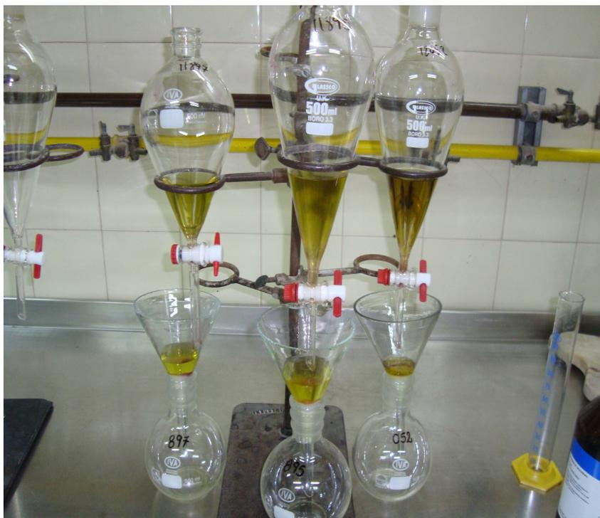
Foto 9: Extracción de residuos, trasvase de fase orgánica a matraz de evaporación. Laboratorio de Fitofarmacia de la EEA Mendoza
