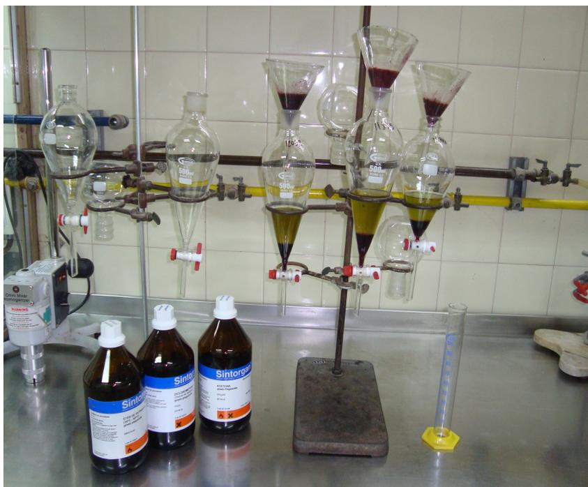
Foto 8: Extracción de residuos, separación de fases.
