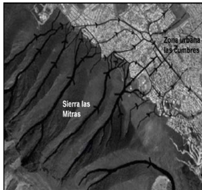
Fig. N° 22. Visualización desde el aire de los torrentes de agua que descienden sobre las colonias
