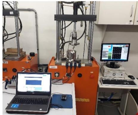
**Figura 9.** Validação experimental – haste femoral de Charnley
