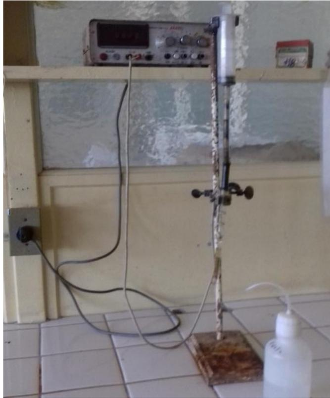
**Figura 23: Conductímetro marca Aradel utilizado para la determinación de la conductividad eléctrica del efluente. Fuente: Propia.**
