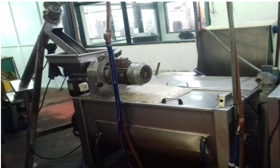
**Figura 12: Molino a martillo y primer máquina termoamadora. Fuente: Propia.**
