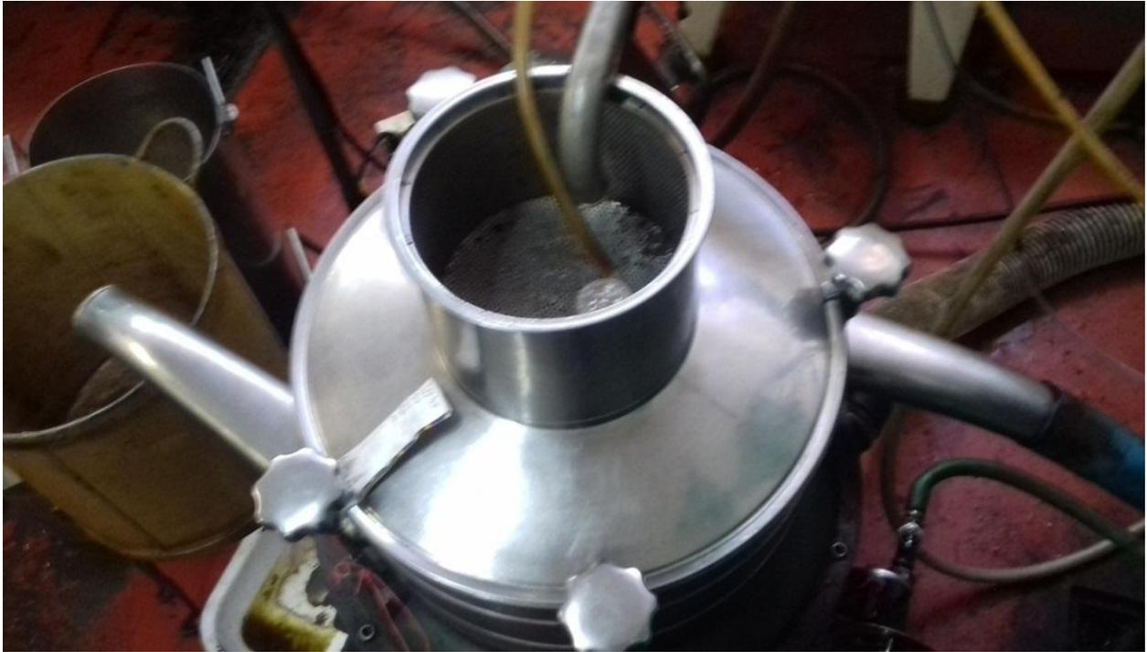
**Figura 16: Centrifugadora vertical. Fuente: Propia.**
