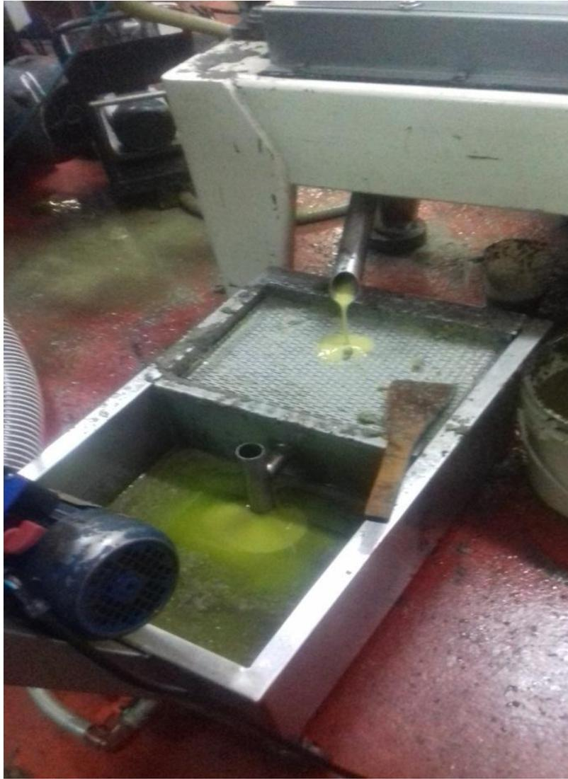
**Figura 15: Salida de aceite del Decanter. Fuente: Propia.**
