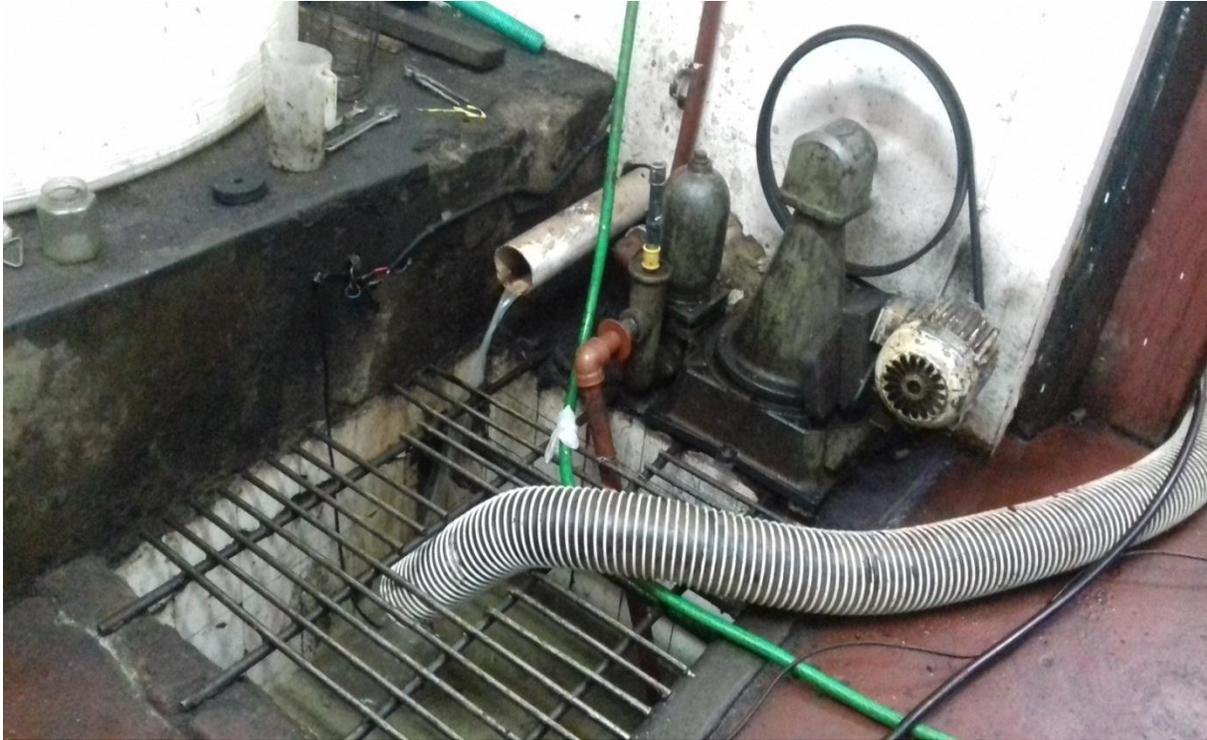
**Figura 26: Pileta receptora de efluentes resultantes de la centrifugación vertical, junto a la bomba de succión. Fuente: Propia.**
