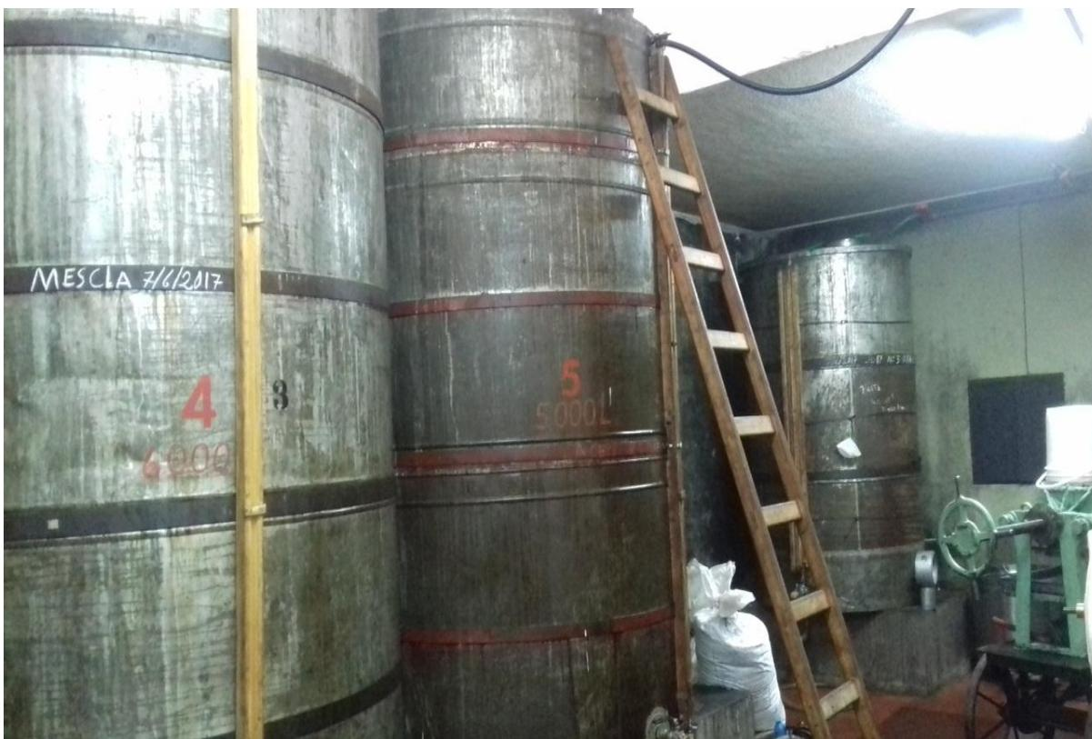
**Figura 17: Tanques de decantación. Fuente: Propia.**
