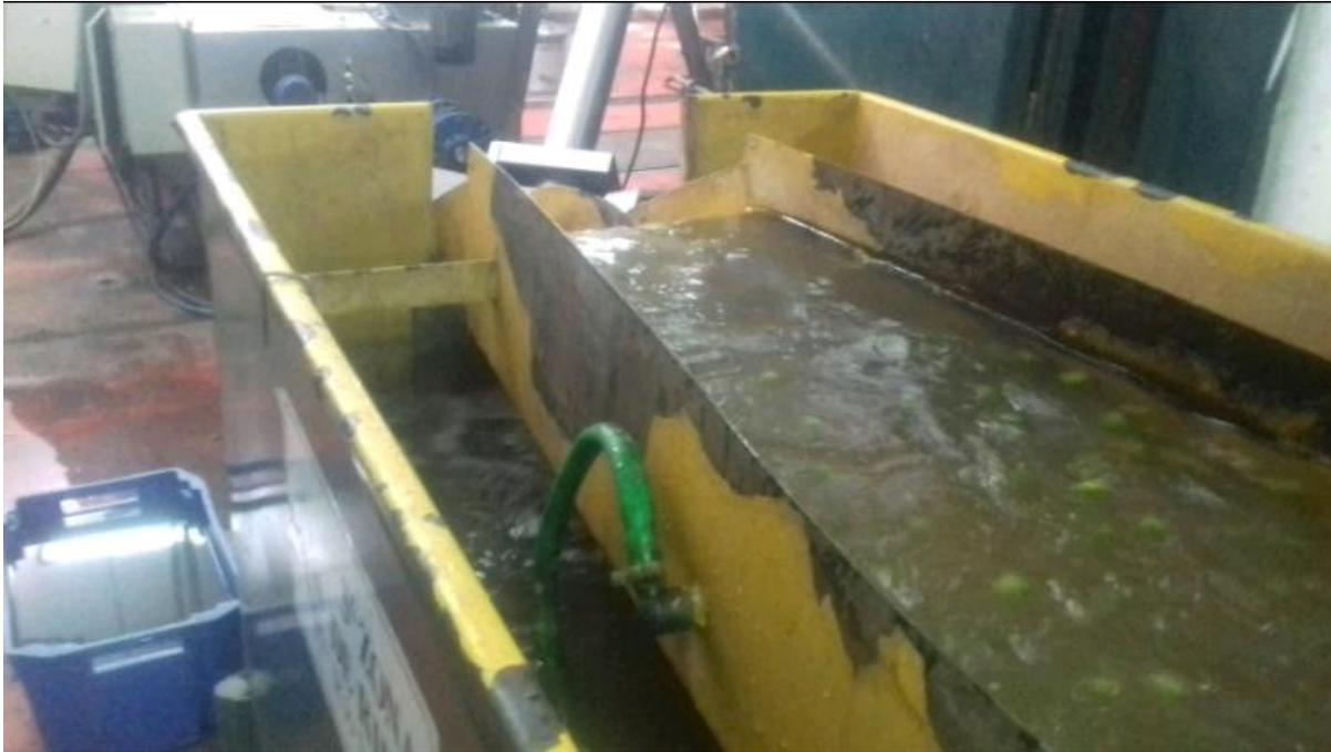
**Figura 11: Cuba de lavado con recirculación de agua. Fuente: Propia.**
