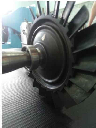
**Figura 6.** Rotor de la turbina terminado.
