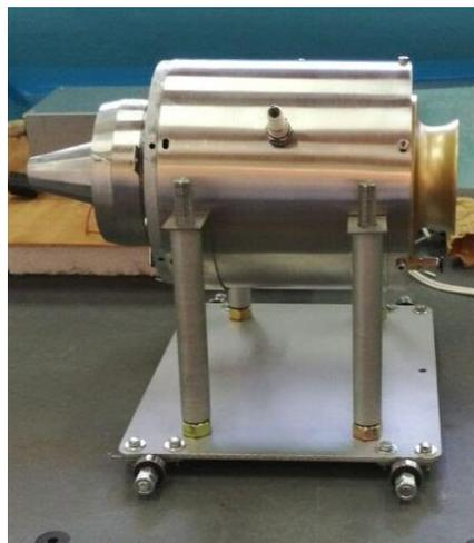
**Figura 7.** Piezas terminadas y motor ensamblado sobre su soporte.
