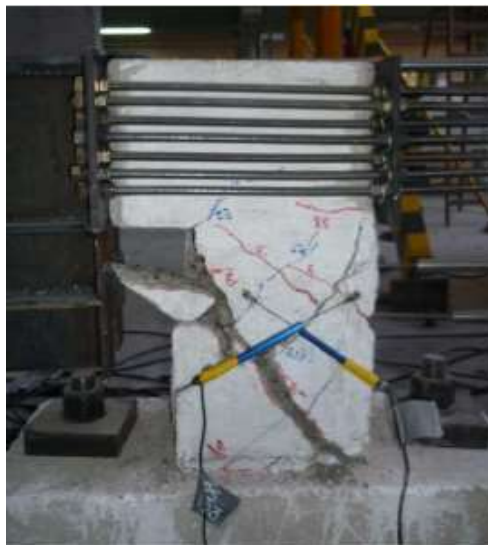
Figura 5. Ensayo de columna a corte
